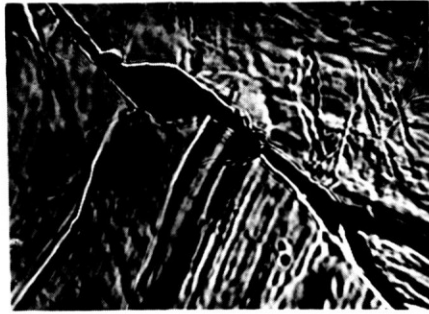
Fig. 15. Tantale: cisaillement aux joints; fluage à 1700°C. Attaque thermique, G = 1\ 000 .
