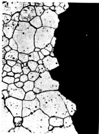
Fig. 16. Tungstène: décohesion intergranulaire; rupture à l'ambiante; G = 200 .
