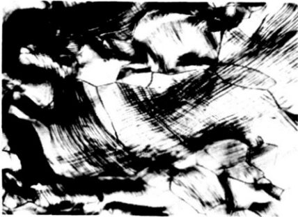
Fig. 12. Tantale: glissements intracristallins; fluage à 800^\circ\text{C} . Attaque thermique, G = 400 .
