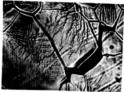
Fig. 13. Tantale: glissements multiples et fissures intercrystalline; fluage à 800^\circ\text{C} . Attaque thermique, G = 1\ 000 .
